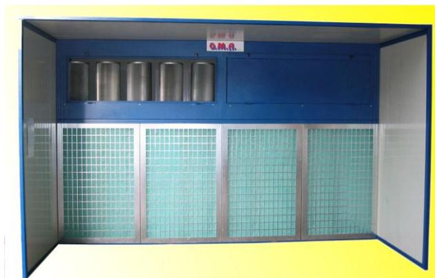
Конструкция изготавливается из сэндвич-панелей. Стенки сэндвич-панелей изготавливаются из покрашенных порошковой краской оцинкованных листов толщиной 30 мм, пространство между которыми заполняется вспененным пенополиуретаном.
