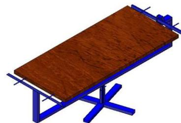
**Стеллаж СТ-1/СТ-1 «М»/СТ-2** – предназначен для сушки и транспортировки любых мебельных деталей. За счет подвижности конструкции (одной или двух средних вертикальных стоек, кроме стеллажа СТ-1 «М» для дверей) можно придавать стеллажу любую необходимую конфигурацию. Допустимая нагрузка на стеллаж до 320 кг, на одну опорную трубку – 5 кг. Стеллаж оснащается транспортными поворачивающимися колесами (D=125 мм) с тормозами для маневрирования. Базовая цена – 50.750/40.500/59.500 руб.
