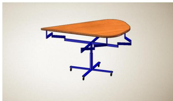
**Стол малярный СМ-3** – предназначен для покраски дверей различных размеров. Маляр может окрашивать деталь со всех сторон, не сходя с места, за счет вращения стола вокруг вертикальной оси. Конструкция стола исключает напыл ЛКМ на обратную (нижнюю) сторону изделия. Габариты окрашиваемых изделий (длина) – 2.000 - 3.100 мм. Стол имеет высоту 800 мм, покрашен порошковой краской. Конструкция позволяет менять положение двери (переворачивать ее) одним маляром. Базовая цена – 36.250 руб.
