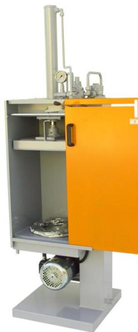
Данное оборудование предельно просто в работе и обслуживании. Вы просто устанавливаете в камеру пустую банку или банки, закрываете камеру и приводите механизм прессования в действие посредством специального рычага, потом открываете камеру и вынимаете уже спрессованный диск, который просто выбрасываете в обычный мусорный бак.
